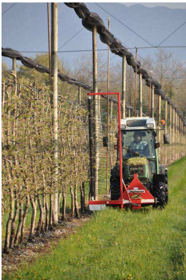
Foto 6 - Diradamento meccanico non selettivo dei mazzetti fiorali con la macchina diradante Darwin. Le prove di diradamento meccanico sono state eseguite presso l'Azienda Rinascita di Spilimbergo (PN) in collaborazione con l'Azienda Agricola Fenos Ennio di Cordenons (PN).
