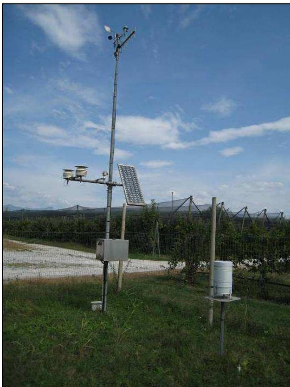
**Foto 2** – Stazione meteorologica in prossimità di un frutteto.
