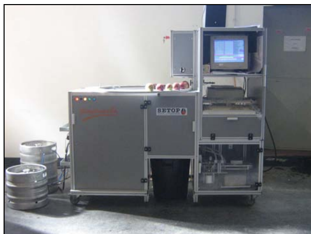
Foto 30 – Analizzatore automatico Pimprenelle.
