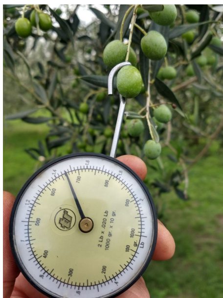
Foto: misurazione del distacco con dinamometro
