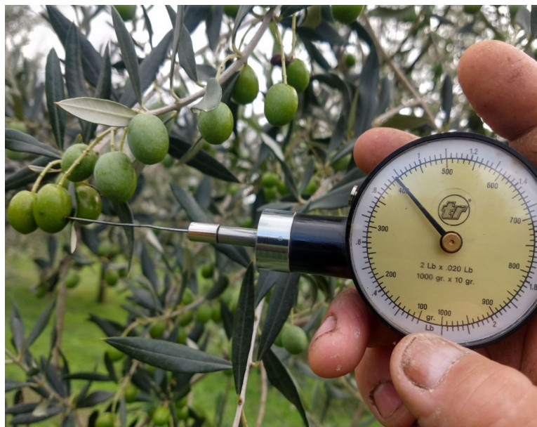
Foto: Misurazione della consistenza della polpa con penetrometro
