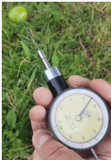
**Foto: Dinamometro e penetrometro**
