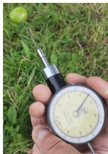
**Foto: Dinamometro e penetrometro**
