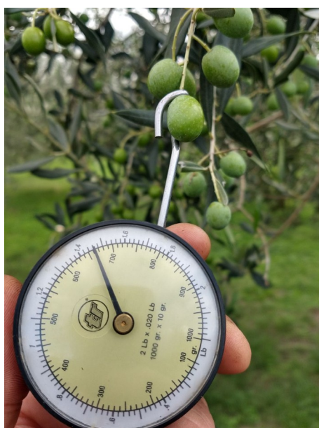
Foto: misurazione del distacco con dinamometro
