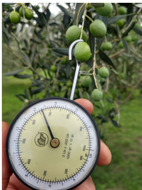
Foto: misurazione del distacco con dinamometro
