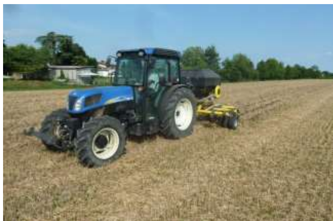
Foto 5. Passaggio di minima lavorazione. La profondità media è stata di 4-5 cm.
