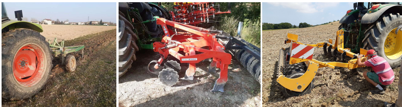
Foto 1. Esempi di attrezzature a denti per lavorazione principale del terreno senza inversione degli strati
