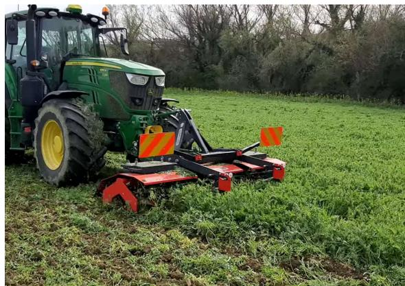
Foto 5. Trinciatura di una intercalare con rulli passivi a lame
